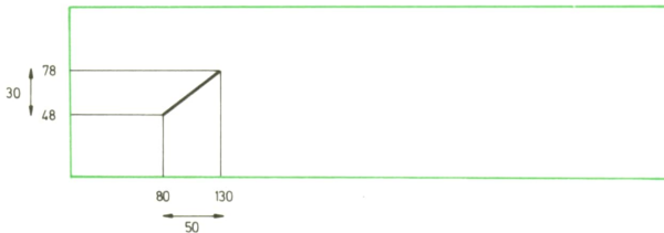
Fig. 5. Ejemplo de funcionamiento de DRAW en el SPECTRUM (DRAW 50,30).
